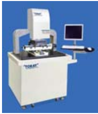
図3 顕微鏡型装置の例 東レエンジニアリング(株)製 表面形状測定装置 SP-700 で、 光学系は防振台上に搭載されて いる。
